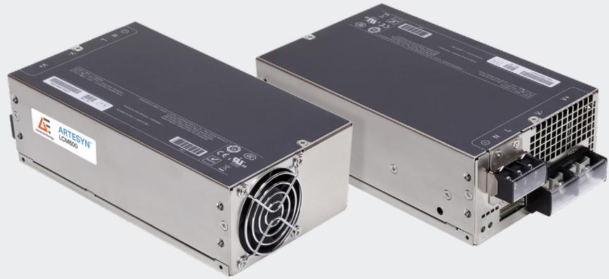
Advanced Energy 的 Artesyn LCM600 系列分布式前端 AC-DC 电源高度为 2U，是一款极具成本效益的大容量电源解决方案。该系列包括 5 种型号，可分别提供 12 V、15 V、24 V、36 V 或 48 V 输出，并可选配 5 V 备用输出。每个型号均接受 85-264 Vac 的通用输入，典型满载效率为 89%。这些电源均通过工业和医疗安全认证，可以提供高达 600 W 的功率，能为工业、医疗、军事和工艺自动化等应用提供多功能、大容量电源。
